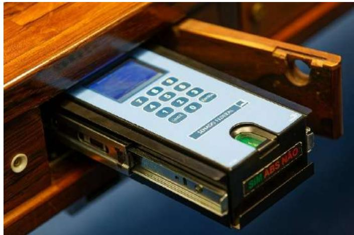
Figura 3 - Posto de votação de bancada, com teclado numérico de membrana e display LCD simples.
