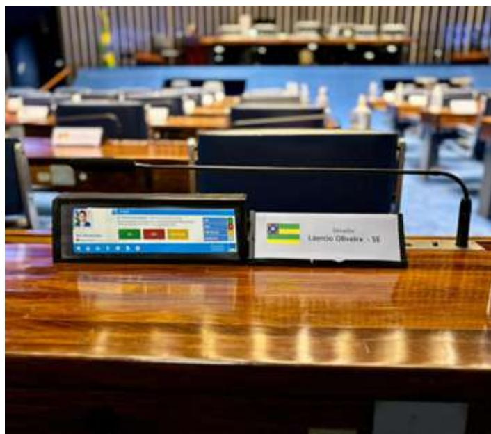
Figura 11 - Maquete do novo prisma de conteúdo dinâmico e prisma estático atual lado a lado.
