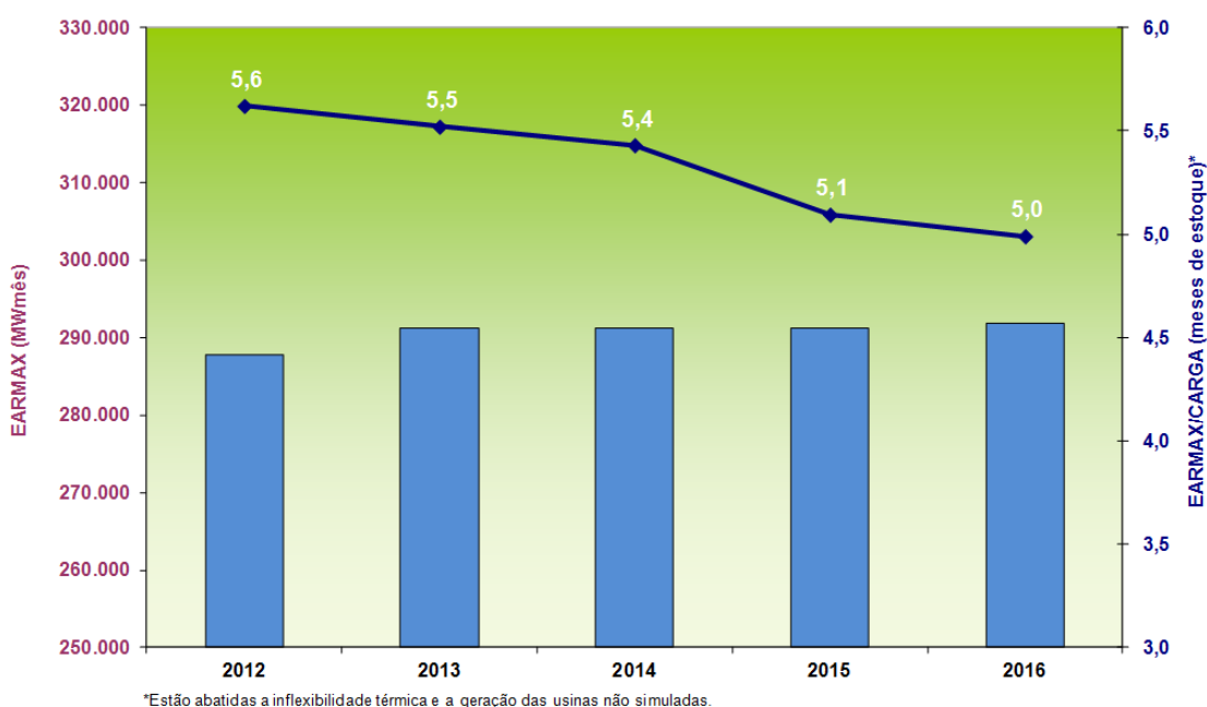
Figura 5: Relação entre Energia Armazenada Máxima e Carga do SIN (projeção 2012-2016)
