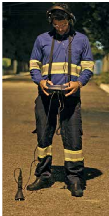
Técnico usa aparelho de geofonia para detectar vazamento de água em Campo Verde (MT): perda de água no Brasil chega a 37%
