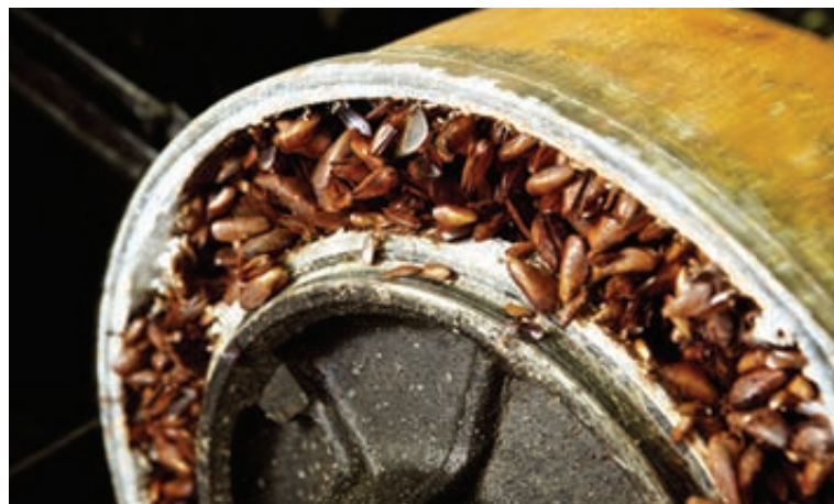
Oriundo da Ásia, o mexilhão dourado causa danos a peças de hidrelétricas
